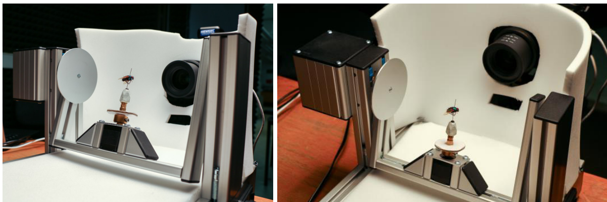
Abb. 8: Blick in das ZooSphere-Tool mit dem Insekt in der Mitte und dem Kameraobjektiv im Hintergrund.
