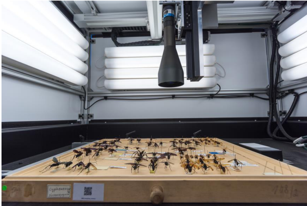
Abb. 3: Blick in den Insektenkastenscanner mit einem Insektenkasten von Wegwespen (Pompilidae).
